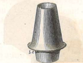
Fig. 172. — Rétrécissement de l'extrémité du tuyau d'une cheminée.
